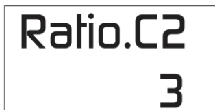
شکل ۸ - نمایش اطلاعات پله های خازنی در منوی Cap.Data روی صفحه نمایش
